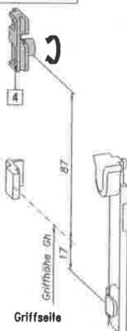
Eckumlenkung mit Scherenriegel und Schubstange einschieben
