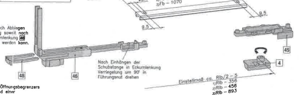
Nach Einhängen der Schubstange in Eckumlenkung Verriegelung um 90° in Führungsnut drehen
