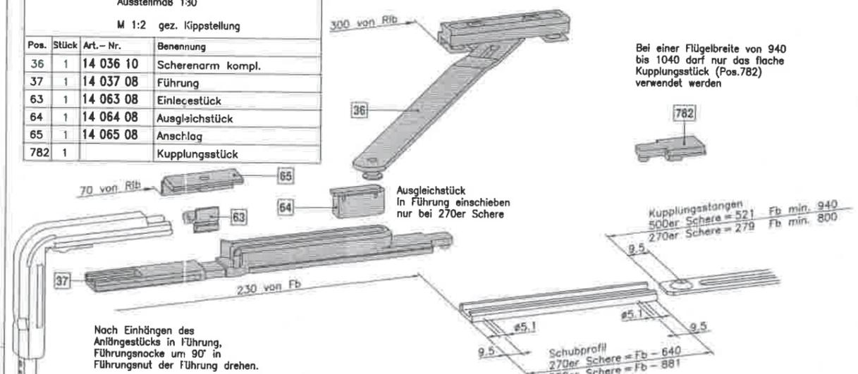
Bei einer Flügelbreite von 940 bis 1040 darf nur das flache Kupplungsstück (Pos.782) verwendet werden
