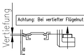
Höhenverstellungsschraube im Klemmstück (Pos.22) pro mm Vertiefung um jeweils 1 Umdrehung nach oben verstellen !
