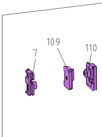
Zusatzverriegelung ist entsprechend der Profilstabilität und der Beanspruchungsgruppe ( A - B - C ) erforderlich. Siehe Angaben des Systemherstellers
