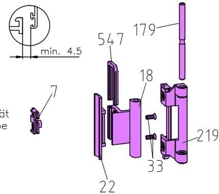
Zusatzverriegelung ist entsprechend der Profilstabilität und der Beanspruchungsgruppe ( A - B - C ) erforderlich. Siehe Angaben des Systemherstellers
